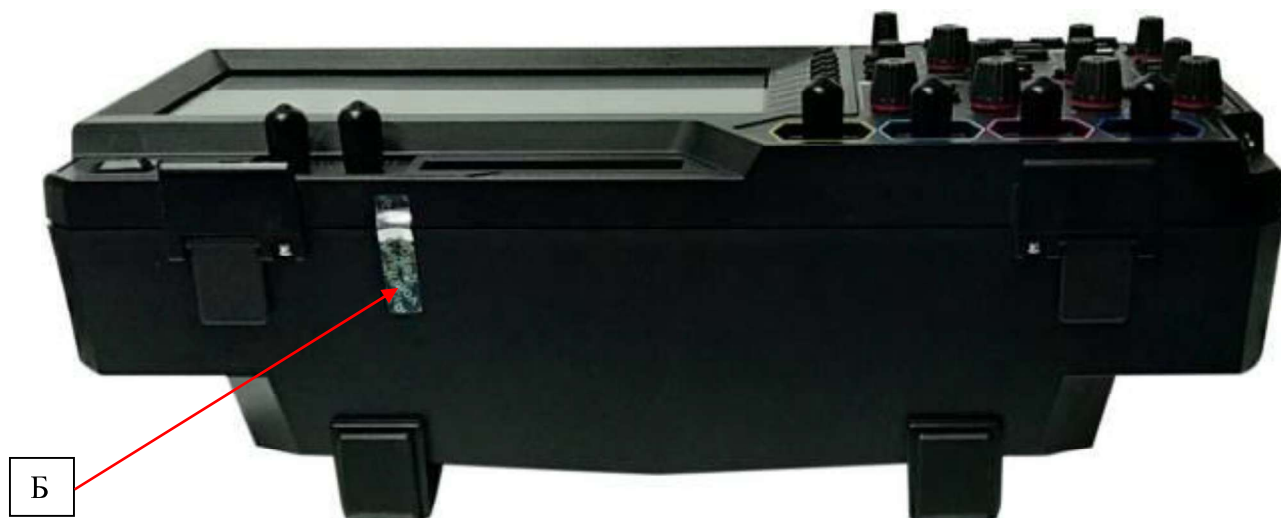
Рисунок 6 – Схема пломбировки от несанкционированного доступа (Б)
