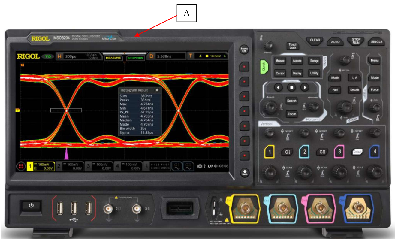
Рисунок 5 – Общий вид осциллографов серии MSO8000 и место нанесения знака утверждения типа (А)
